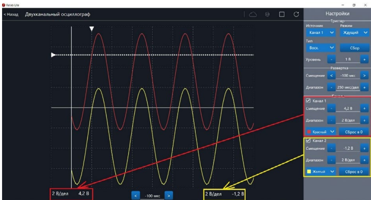
Рис. 39. Использование блока Каналы
